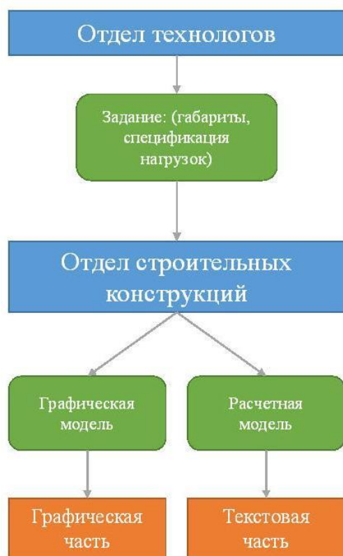
Рис. 1. Стандартный процесс проектирования опорных конструкций.
